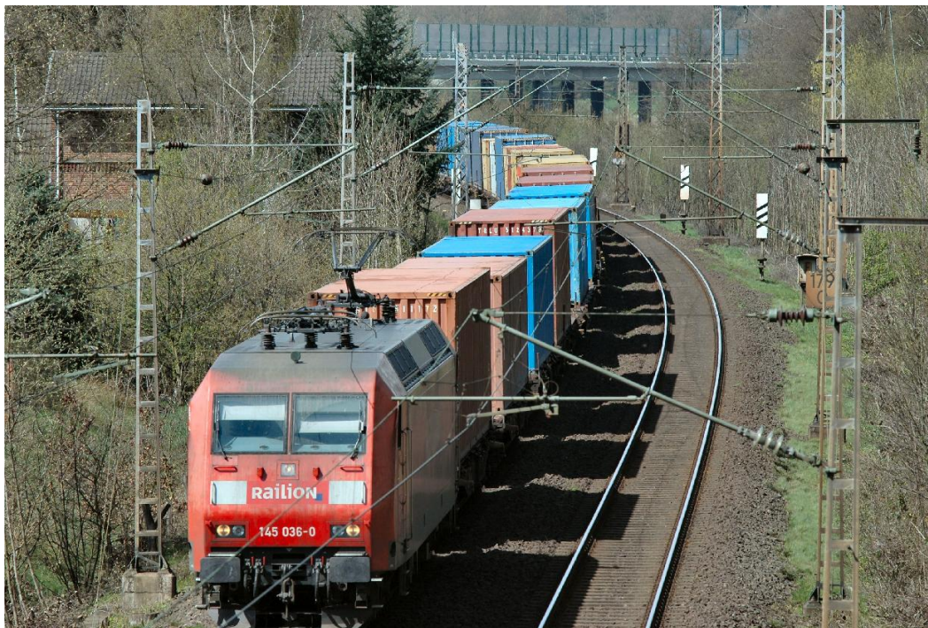
Abb. 26 E-Lok BR 145 mit Containertragwagen in Fahrtrichtung Süden an der Autobahnbrücke Bremerhaven-Wulsdorf, bremenports
